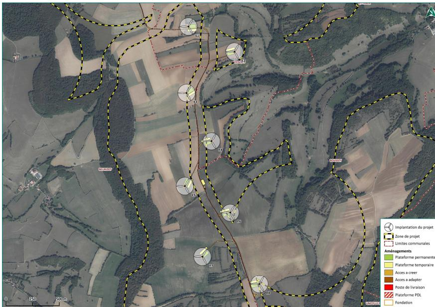
Cette implantation comporte 8 éoliennes, 2 sur Boussey, 3 sur Beurizot et 3 sur Vesvres, d'une puissance comprise entre 4,5 et 5,9 MW, soit une puissance totale du parc allant de 36 à 47,2 MW.
